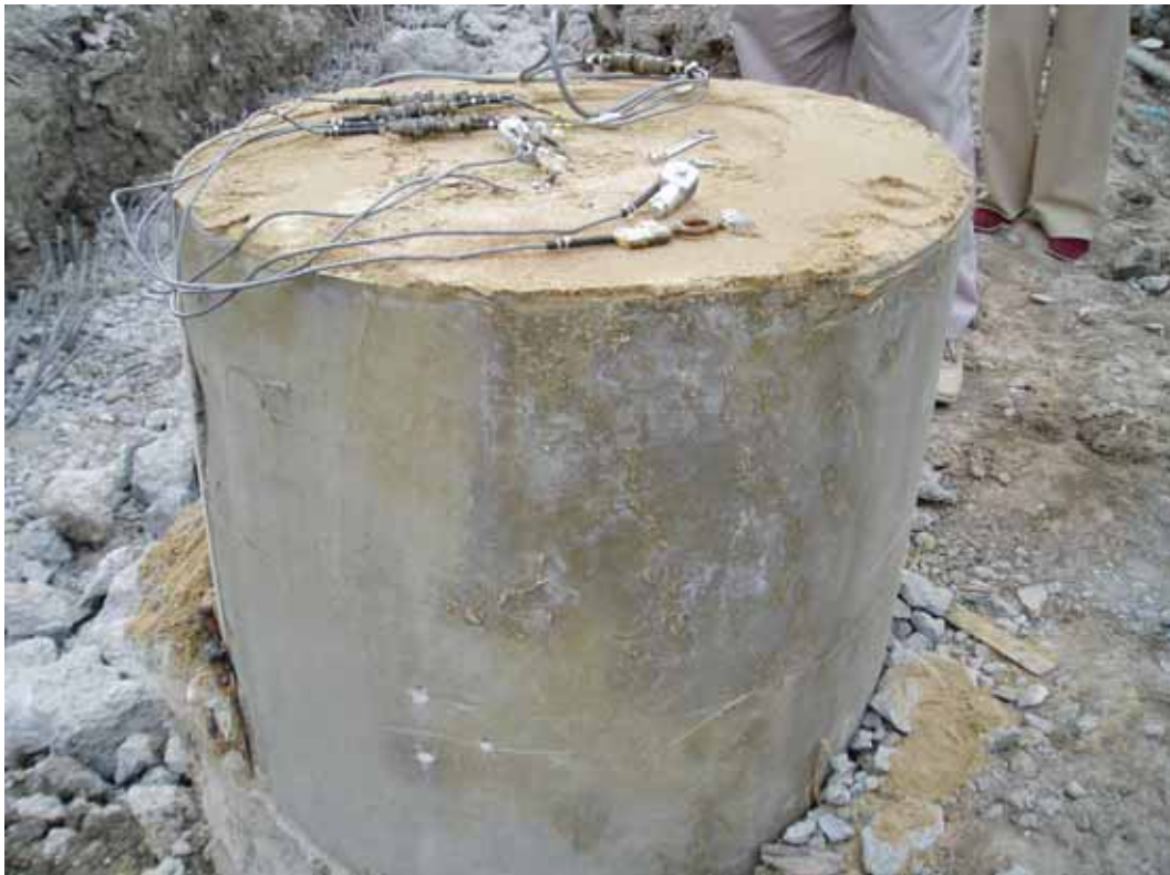
D . 锤的底面与桩面都要水平、平整
