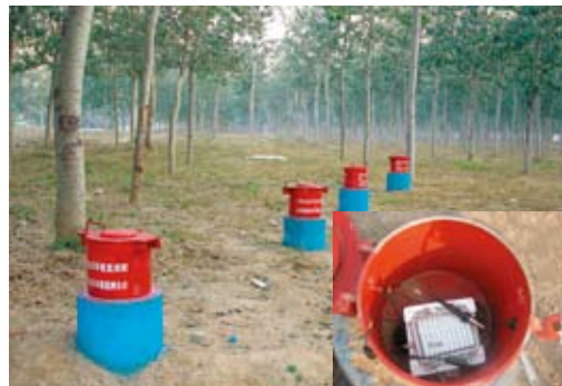
地下水监测孔保护设施与自动传输装置
