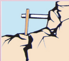
裂缝壁上安装标尺
