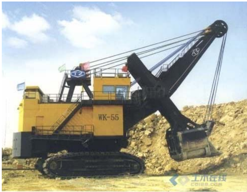
太原重工 wk-55,标准斗容 55m 3 提升电机额定功率 2x1000kW 斗容范围 36m 3 -76m 3 最大挖掘半径 23.85m 提升速度 0.76-1.58m/s 最大挖掘高度 18.10m
