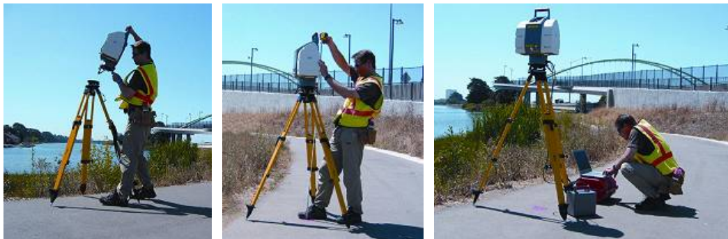
图 4.4.5 操作流程：设站、量仪器高、扫描参数设定
