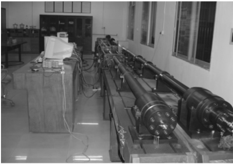
图 1 SHPB 实验装置及测试系统
