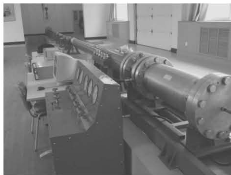
图 1 \Phi 100 mm SHPB 设备
