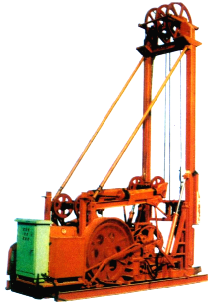
图 1—10 CZF-30 型冲击反循环钻机
