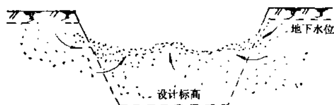
图 1-1 基坑流砂现象
