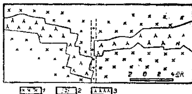
圖 8. 沿走向被較老花崗斑岩岩牆所 限制的複雜階狀閃長玢岩岩牆平面圖 (根據A.B.德魯日寧)
