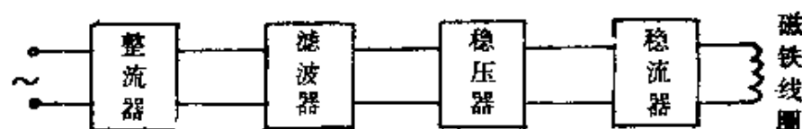
图 4.3.4 电磁铁电源方框图
