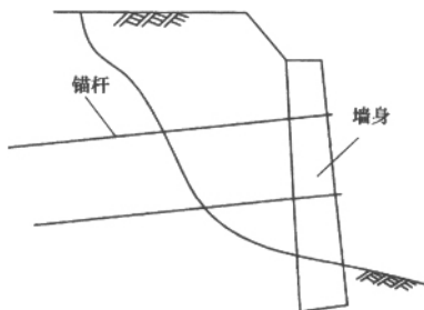
图 4-5-12 重力式锚杆挡土墙
