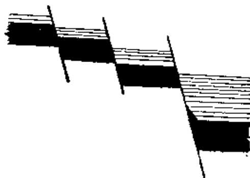
图 20 根据小断层推断大断层
