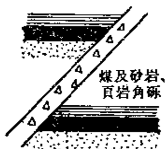
图 22 根据断层角砾推断断层
