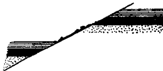
图 23 根据煤线推断煤层
