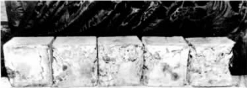
图 1-1-2 混凝土试块受压破坏图
