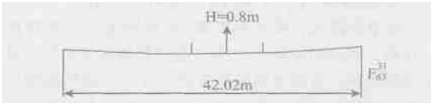
图 2 断层落差与水平延伸长度示意图
