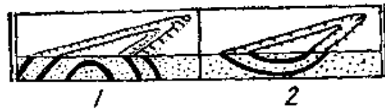
(甲) 外倾转折端和內倾转折端 1—倾伏背斜外倾转折端, 2—倾 伏向斜內倾转折端
