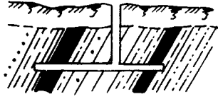
图4-1-4 探井配合石门揭露煤系、煤层示意图
