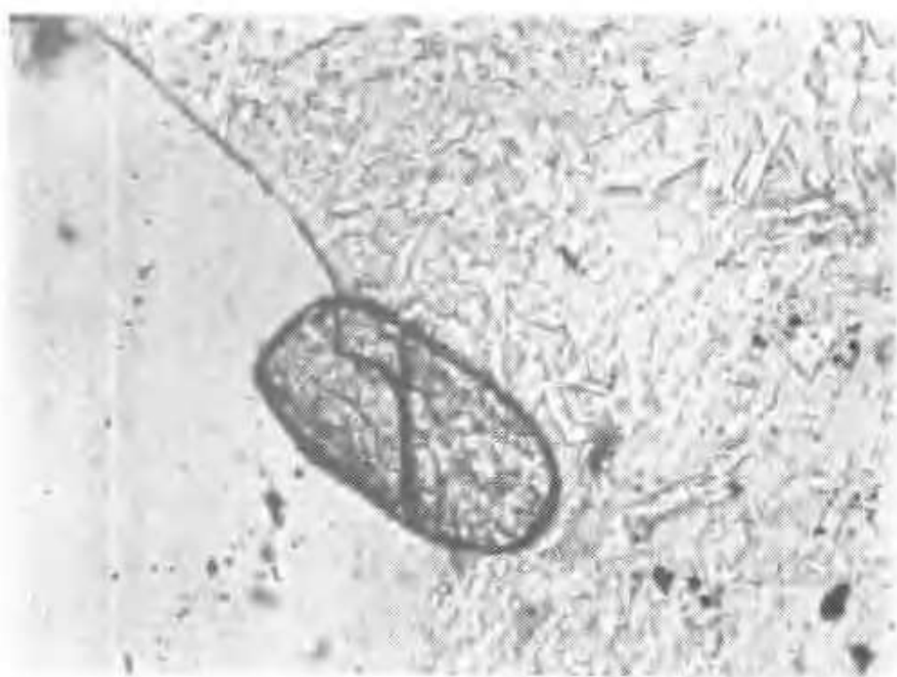
图版 I—2 禄格庄组底部变质砂岩 锆石碎屑呈磨圆状, 具压裂纹 ( \times 250 )
