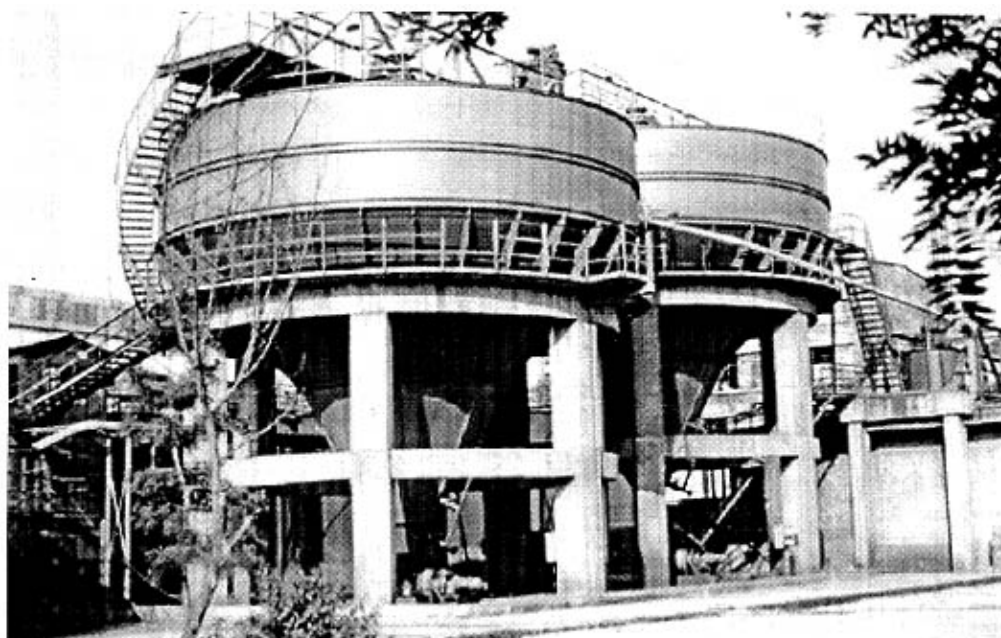
图1-5 长沙矿冶研究院 \Phi 12\text{m} 深锥浓密机
