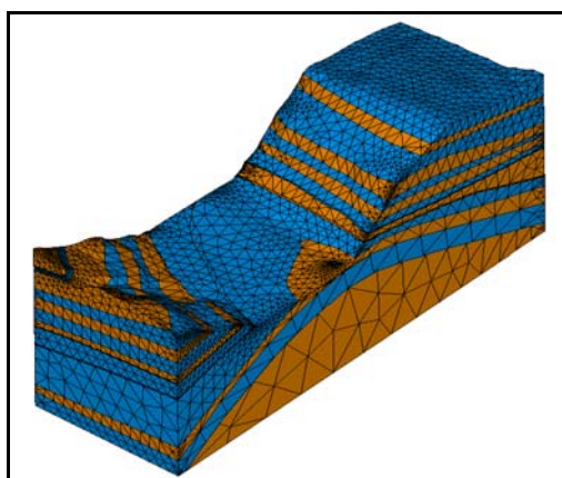
(c) 水平层状岩层的有限元网格剖分图
