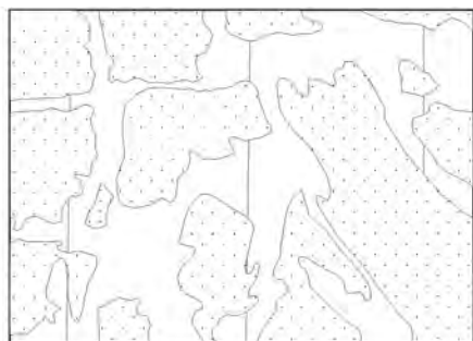
图11-2 线段法测定矿物相对含量示意图
