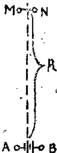
圖 8. 偶極電測深的電極裝置 (俯視)
