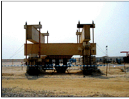
图 9-1 静载荷试验仪
