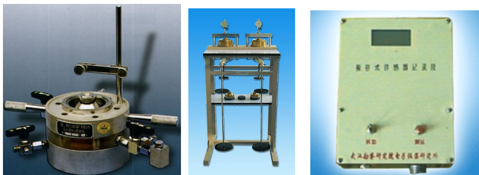
图 2-1 k_0 固结仪、高压固结仪、孔隙水压力测定仪
