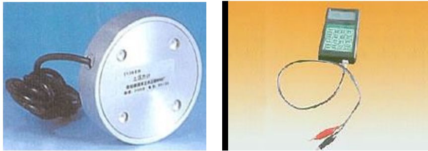
图 1-1 土压力计和频率读数计
