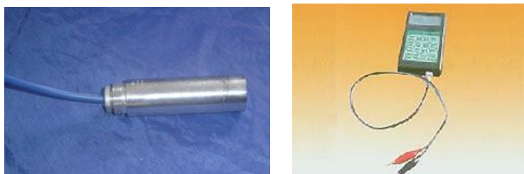
图 3-1 孔隙水压力计、频率读数计
