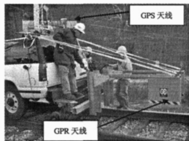
图1 安装在公铁两用车上的 GPR 天线
