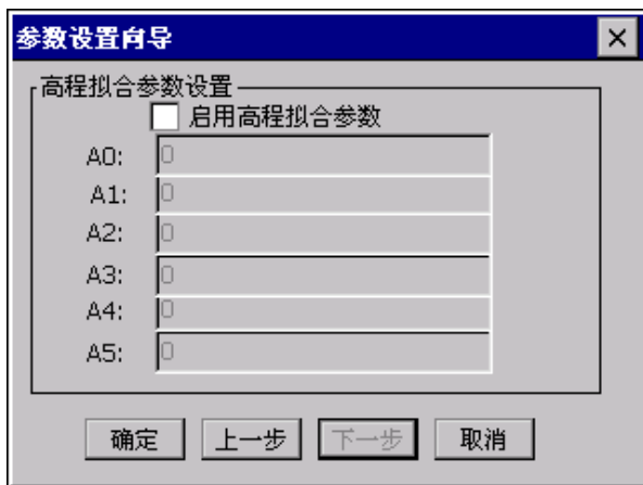
图 2-8 高程拟合参数设置
