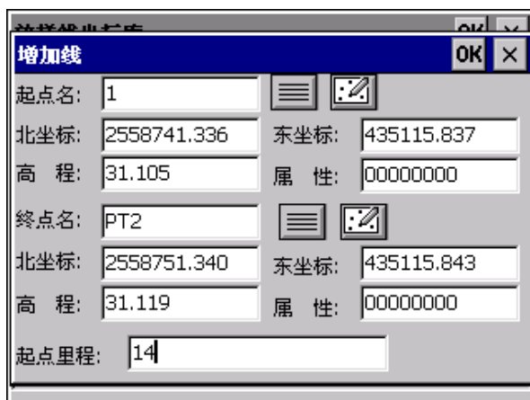
图 4-17 放样线的编辑
