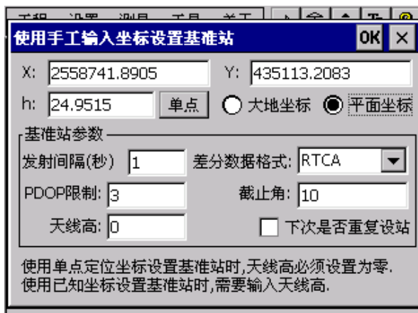
图 3-51 手工输入直角坐标
