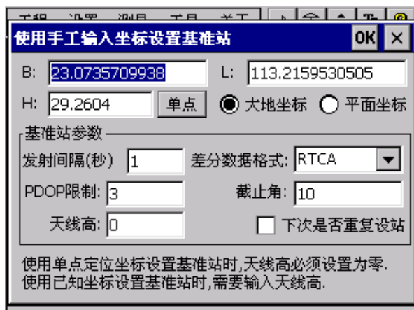
图 3-50 手工输入大地坐标
