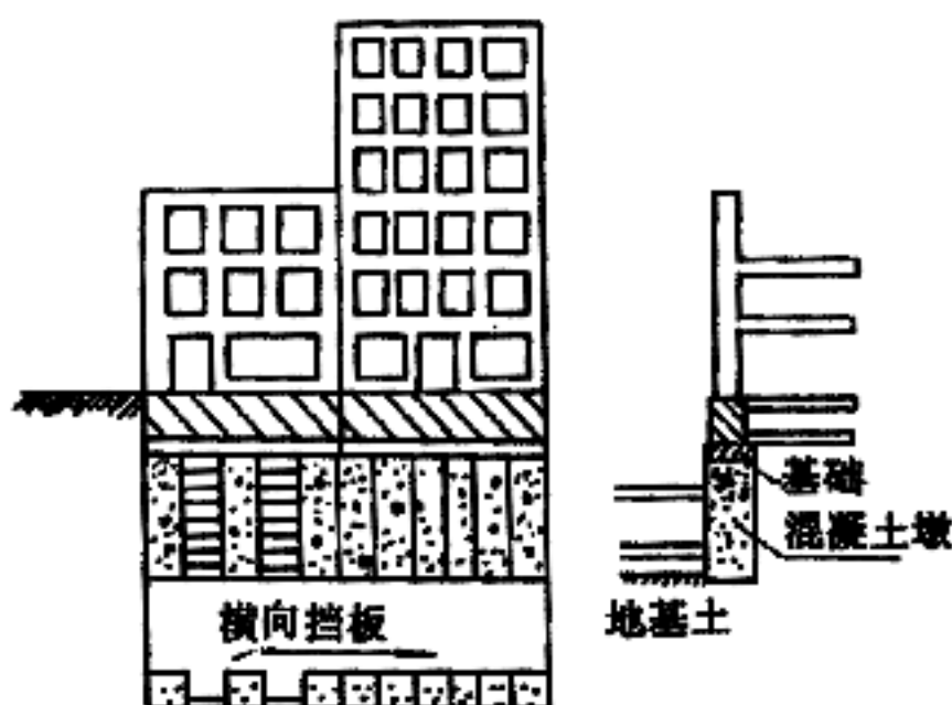
图 6.3.10 间断和连续的混凝土墩式加固
