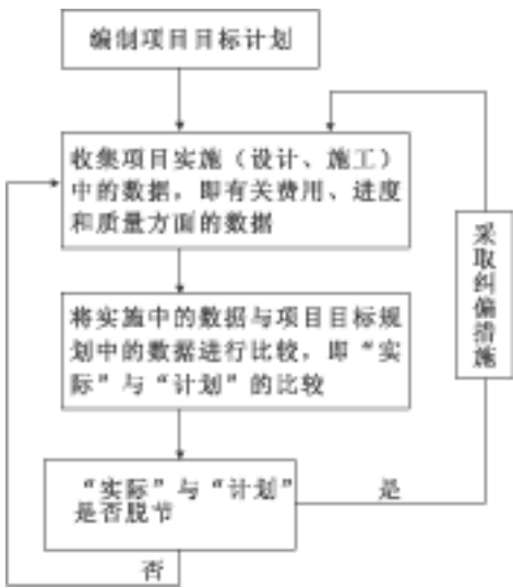
图 源瑶瑶建设工程监理目标控制过程
