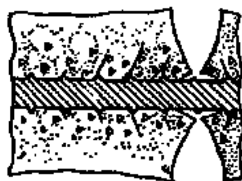
说明图 2.4.16—2 裂缝外形与内部微裂图
