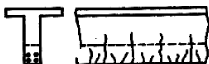
说明图 2.4.16—3 大梁裂缝分布形态图
