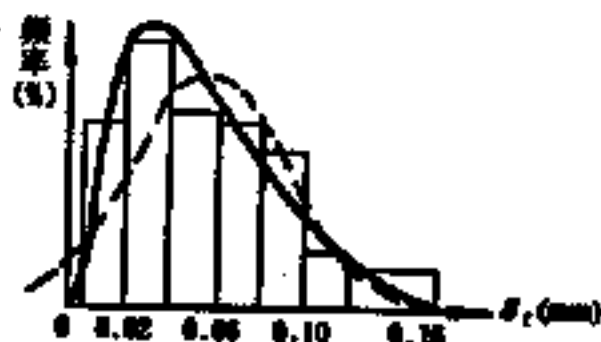
说明图 2.4.16—5 某试件裂缝宽度频率分布示意图
