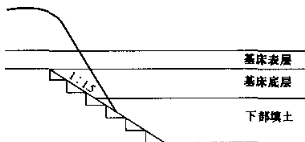
图 7.5.2—2 路堤与软质岩石、土质路堑过渡段设计图
