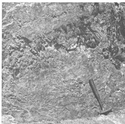
图5 断层面上发育的镜面、擦痕及孔雀石薄膜
