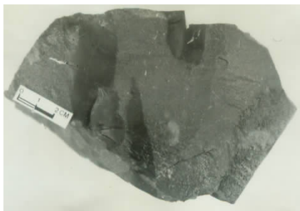
图 5 由含铜细碎屑(浅灰色)胶结泥质粉砂岩角砾(深灰色)形成的液压角砾岩(东天山达坂城铜矿)
