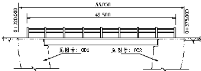
图 A13 用假想线表示与本图相连部分示意图
