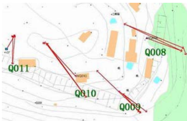
图 9 巫山县 WZB 边坡倾斜变形矢量图
