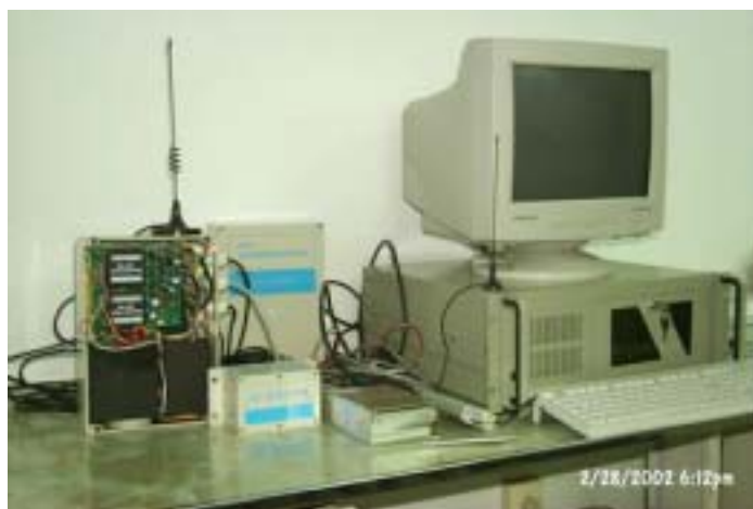
图1 GPRS滑坡无线遥测系统构成
